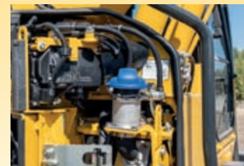
Der AdBlue®-Tank ist an der vorderen Leiter installiert und somit leicht zu erreichen.
